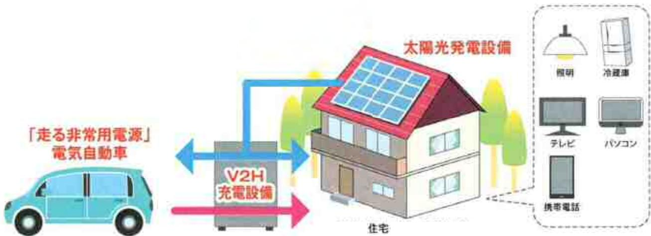
V2H(ヴィークル・トゥ・ホーム)は電気自動車などに搭載された電池から家庭に電力を供給できる設備です。電気自動車の電池を非常用電源として活用したり、電気自動車に貯めた電気を上手く利用して電気代を節約することができます。
